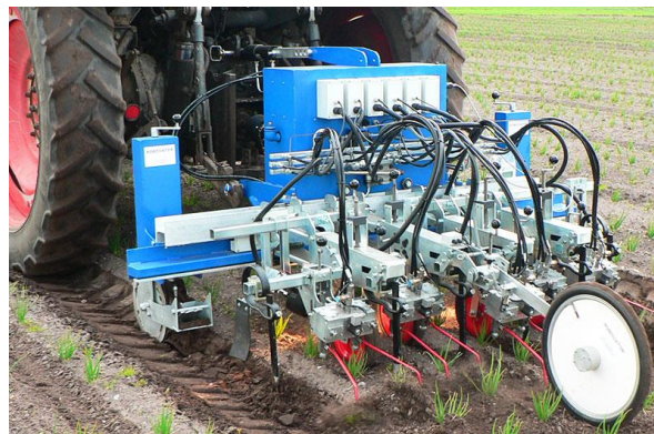
Slika 12. Robovator u povrćarskoj proizvodnji (Izvor: https://www.visionweeding.com/robovator-mechanical/ )
