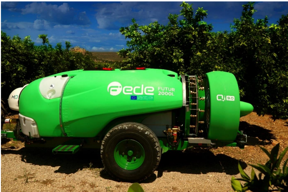
Slika 13. Smartomizer – pametni atomizer (Izvor: https://platform.innoseta.eu/product/31 )
