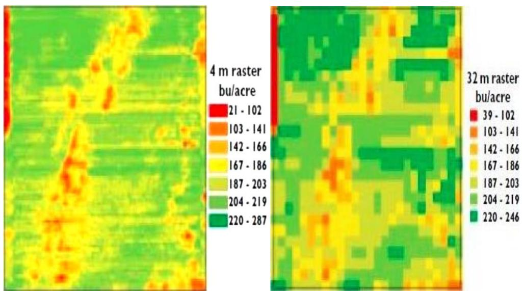
Slika 29. Interpolirana karta uroda s rasterom od 4 m (lijevo) i 32 m (desno) rezolucijom
