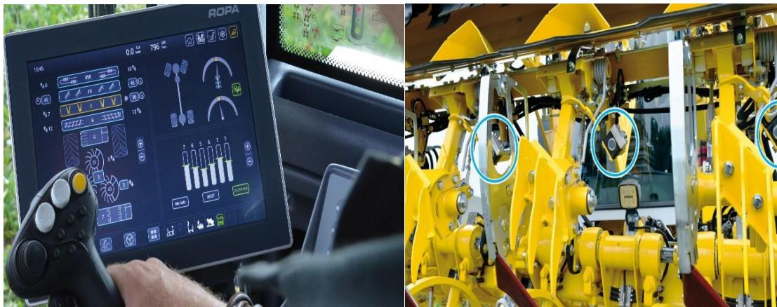
Slika 26. Ultrazvučni senzori koji bilježe konturu tla
