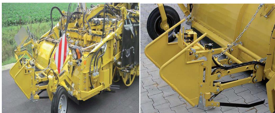
Slika 21. Mehaničko rješenje navigacije redova kroz sustav prepoznavanja lišća (lijevo), te sustav prepoznavanja korijena šećerne repe (desno)
