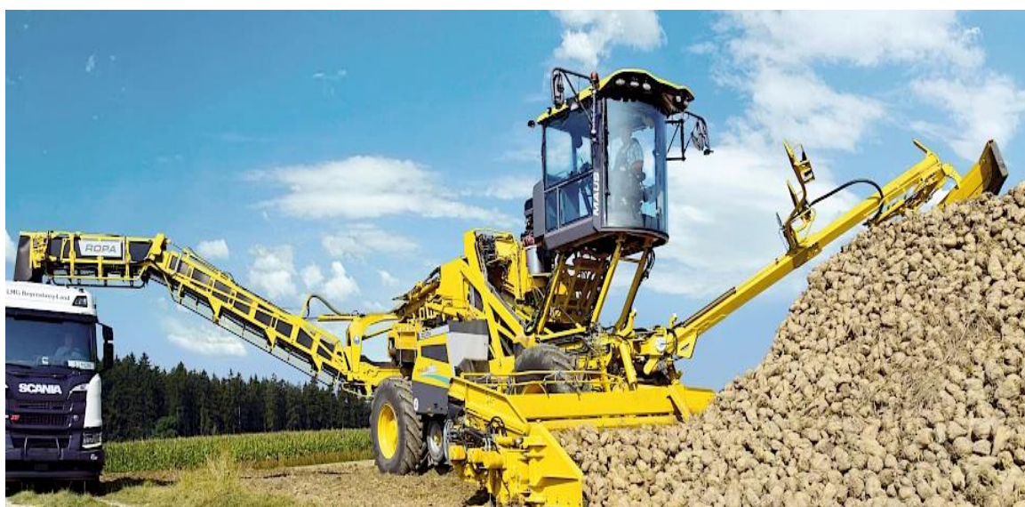
Slika 13. Pročišćavanje šećerne repe (Izvor: https://www.ropa-maschinenbau.de/en/products/ )
