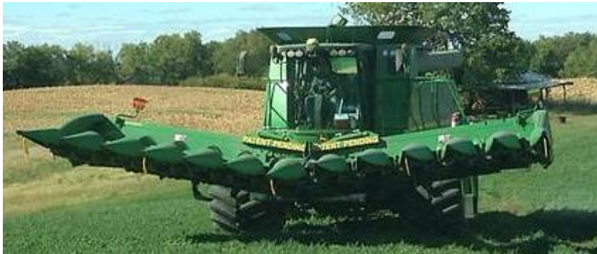
Slika 15. Split-Flex heder za ubiranje kukuruza
