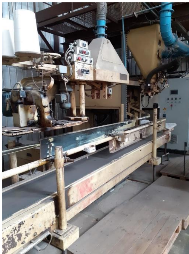
Slika 9. Stroj za šivanje vreća (Izvor: Vlastita fotografija)
