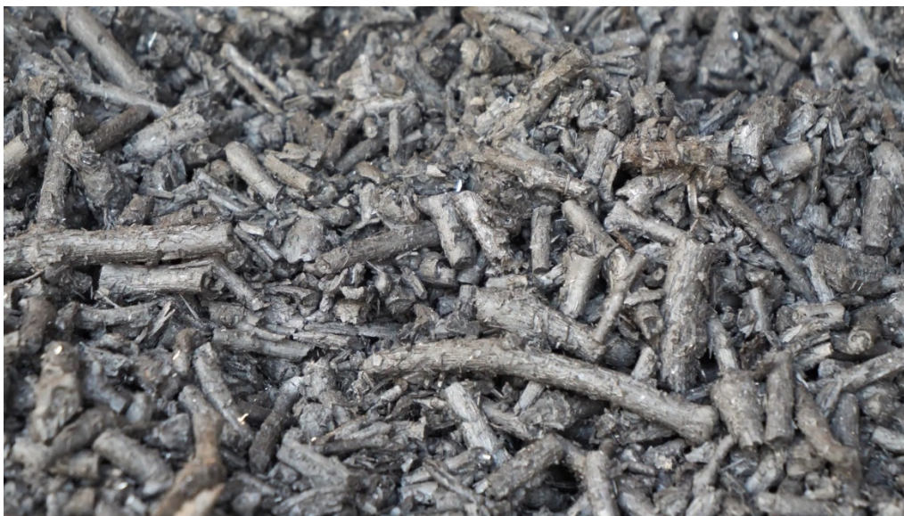
Slika 13. Prikaz biougljena proizvedenog od komadića vinove loze
