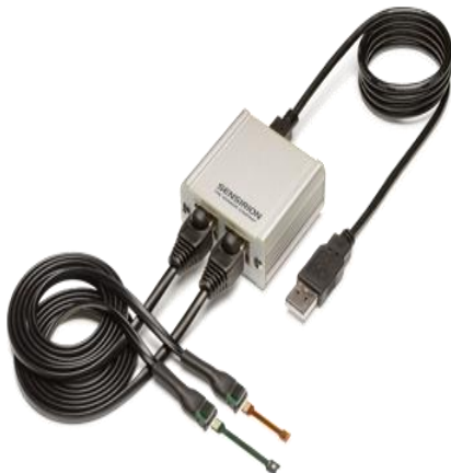
Slika 10. Senzor okoliša sa Sensirionovim kompletom za procjenu
