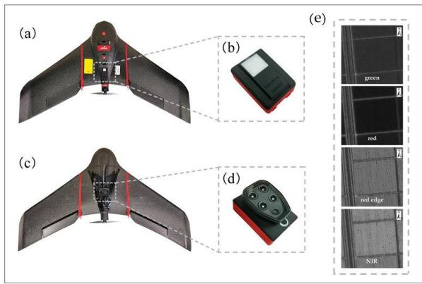
Slika 23. Bespilotni zrakoplov Sense Fly eBee SQ i njegovi dijelovi
