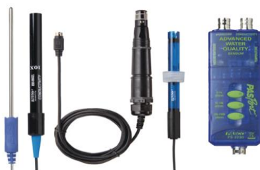
Slika 38. Senzor kvalitete vode
