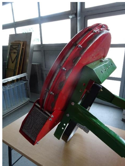
Slika 4. Ventilator PSK4 OLT sijačice
