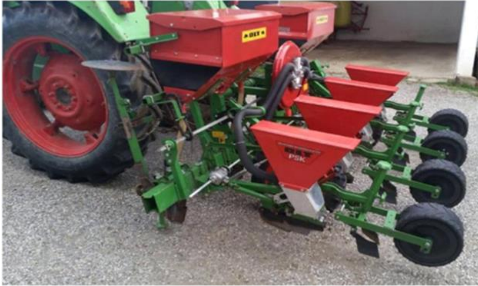
Slika 2. Pneumatska sijačica PSK4 OLT
