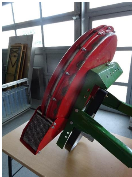
Slika 4. Ventilator PSK4 OLT sijačice
