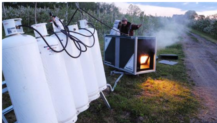
Slika 10. Korištenje prijenosne peći za izravno grijanje
