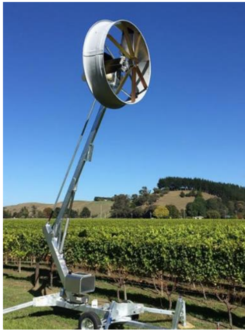
Slika 14. Ventilatori za zaštitu od proljetnog mraza
