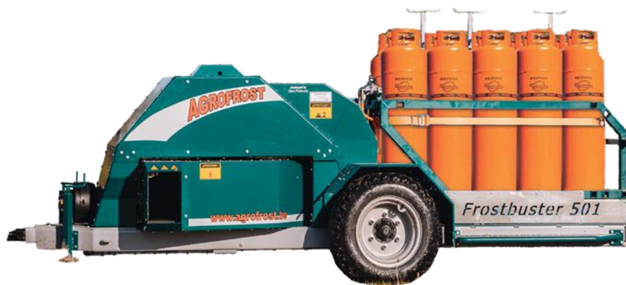
Slika 11. Mobilni generator topline
