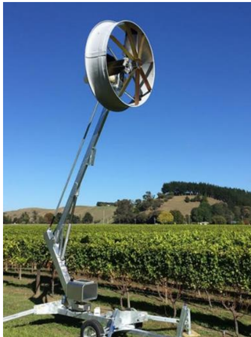
Slika 14. Ventilatori za zaštitu od proljetnog mraza
