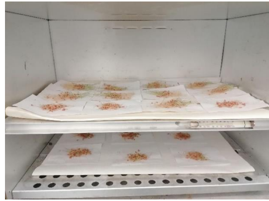
Slika 10. Sušenje uzoraka u sušioniku (izvor: Živković, J.)
