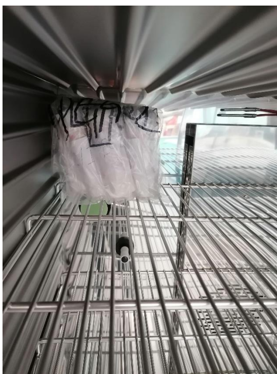
Slika 5. Uzorci u klima komori na temperaturu od 17 °C (izvor: Živković, J.)
