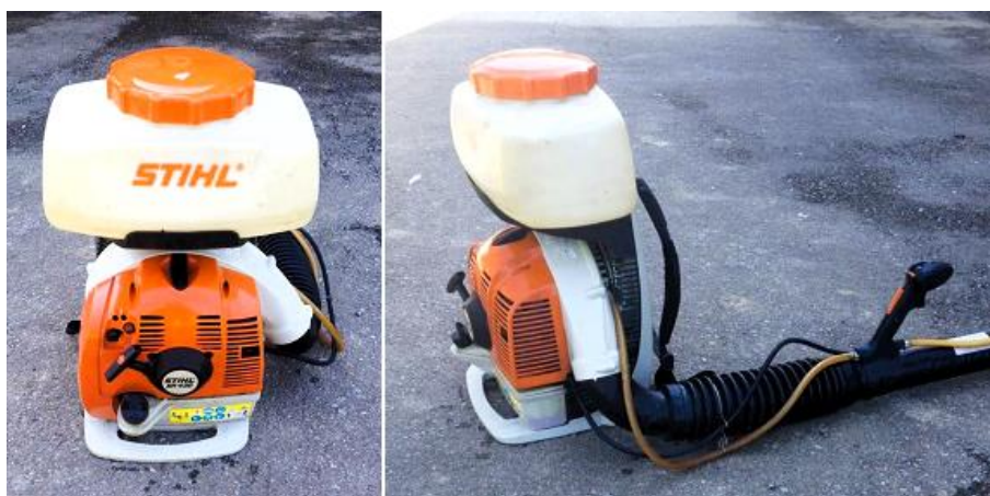
Slika 24. Leđna motorna prskalica Stihl SR 430 (Foto: Autor, 2023.)
