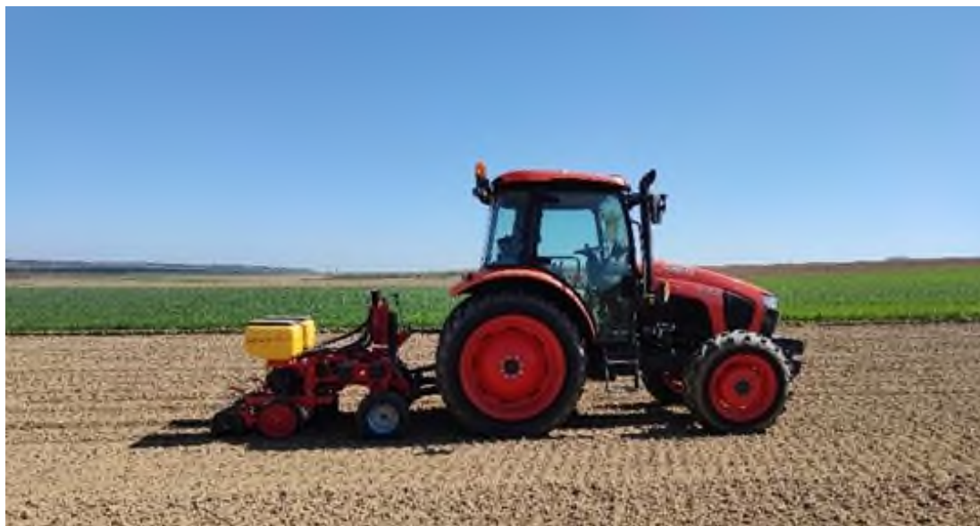
Slika 1. Sjetva suncokreta sijačicom MaterMacc Twin Row-2
