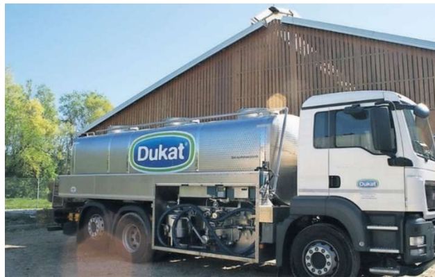
Slika 26. Autocisterna sa spremnikom od nehrđajućeg čelika
