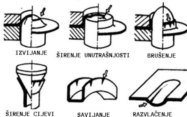
Slika 19. Različite metode oblikovanja gdje granica deformacije može biti povezana s lokaliziranim grlom
