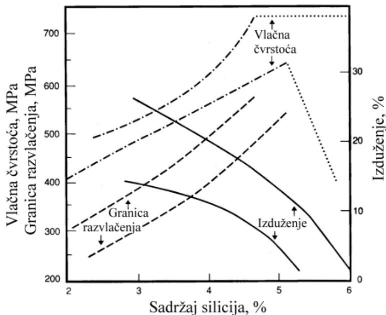
Slika 5. Utjecaj udjela silicija na granicu razvlačenja, vlačnu čvrstoću i istezljivost feritnog nodularnog lijeva pri sobnoj temperaturi
