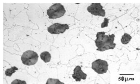
Slika 2. Mikrostruktura nodularnog lijeva s feritnom matricom
