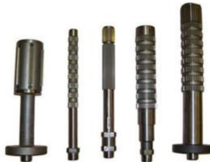
Slika 21. Dugačke igle (vučeni alati) (Slade, 2004.)
