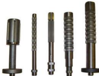
Slika 21. Dugačke igle (vučeni alati) (Slade, 2004.)
