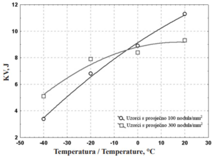
Slika 4. Ovisnost udarne radnje loma o temperaturi i broju nodula/mm<sup>2</sup> kod taljevine feritnog nodularnog lijeva
