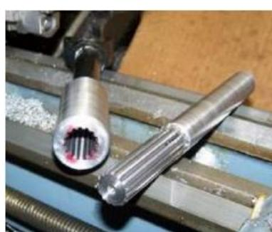
Slika 24. Obradak i alat kod provlačenja
