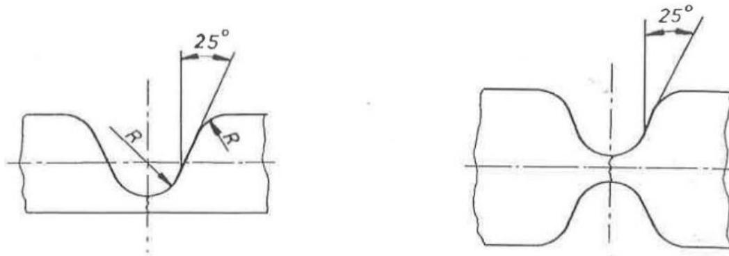
Slika 7. Oblik i priprema žljeba za zavarivanje nodularnog lijeva na hladno
