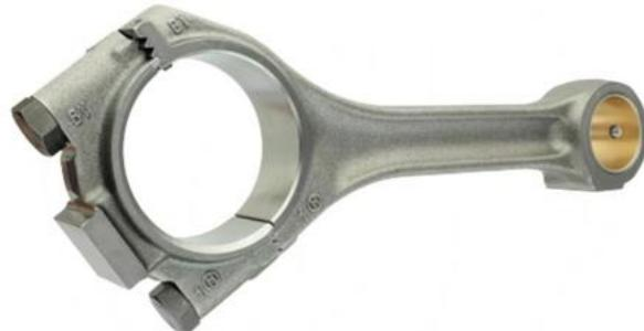
Slika 13. Klipnjača izrađena od poboljšanog nodularnog lijeva
