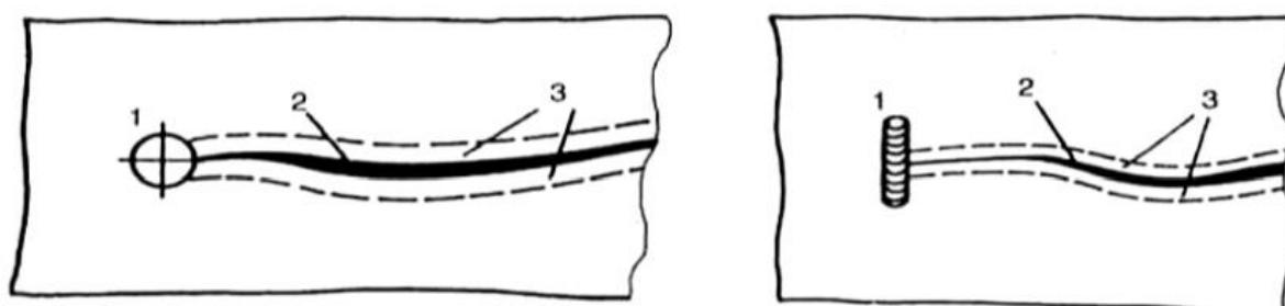
Način pripreme spoja za zavarivanje sivog lijeva na hladno
