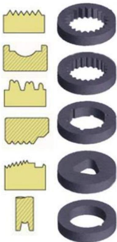
Slika 20. Primjeri obrađenih površina kod vanjskog i unutarnjeg provlačenja
