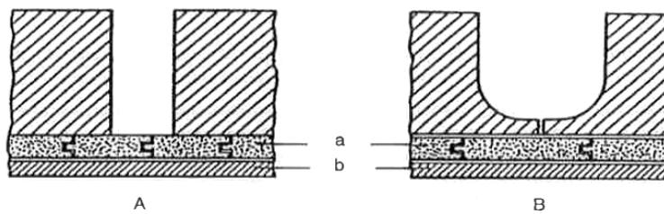
Priprema žlijeba za zavarivanje dijelova od sivog lijeva postupkom na toplo
