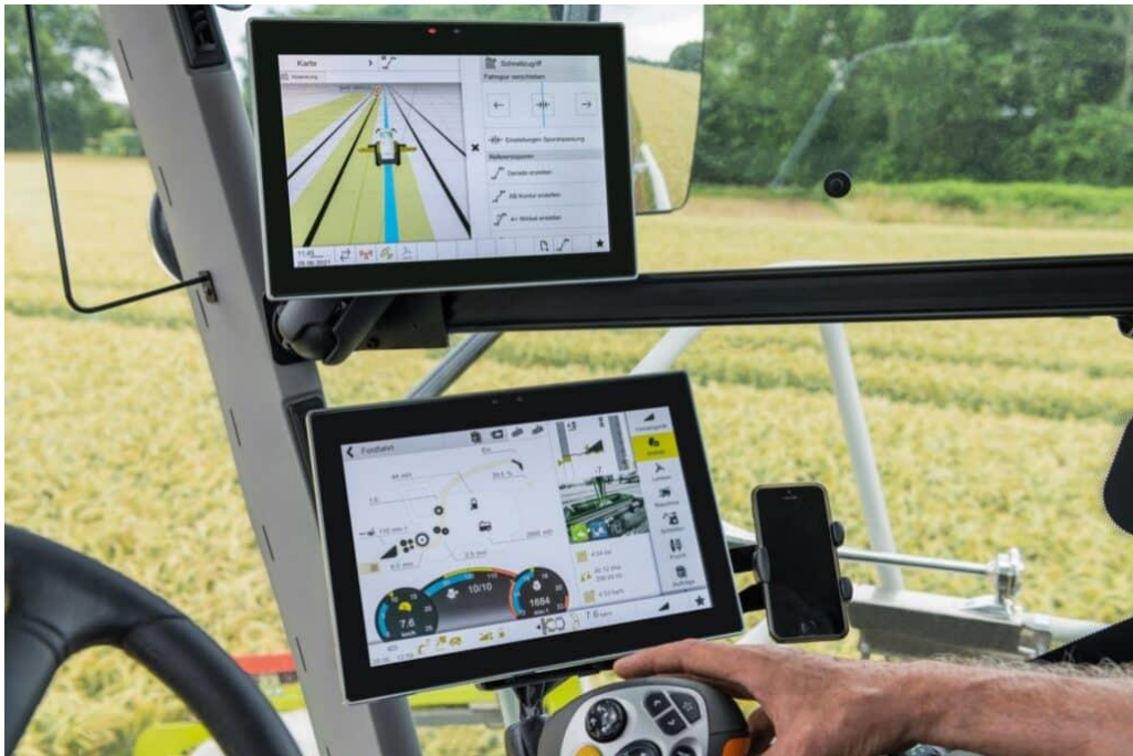
Slika 30. Prikaz praćenja izvršaja i GPS sustava iz kabine novog “Claas Jaguar“ silažnog kombajna
