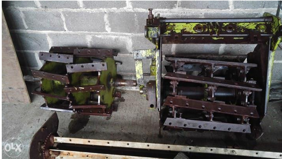
Slika 19. Buban na kombajnu “Claas Jaguar”
