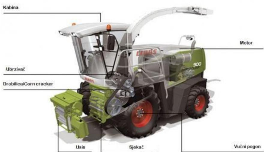
Slika 24. Shematski prikaz silažnog kombajna “Claas Jaguar”
