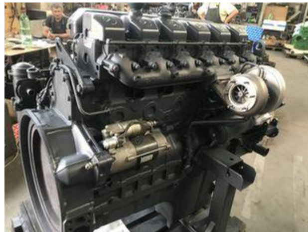
Slika 16. Mercedes Benz motor snage 430 kW
