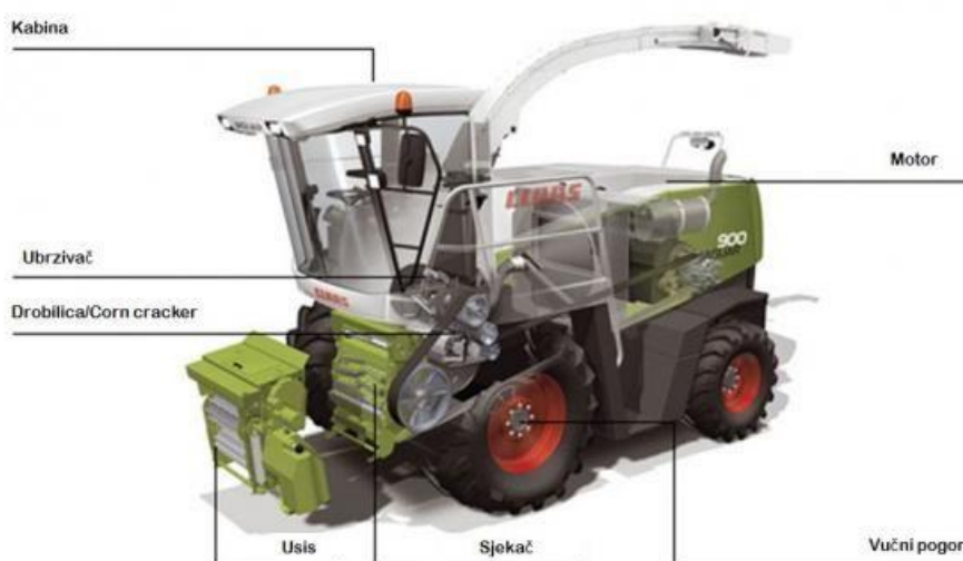
Slika 24. Shematski prikaz silažnog kombajna “Claas Jaguar”
