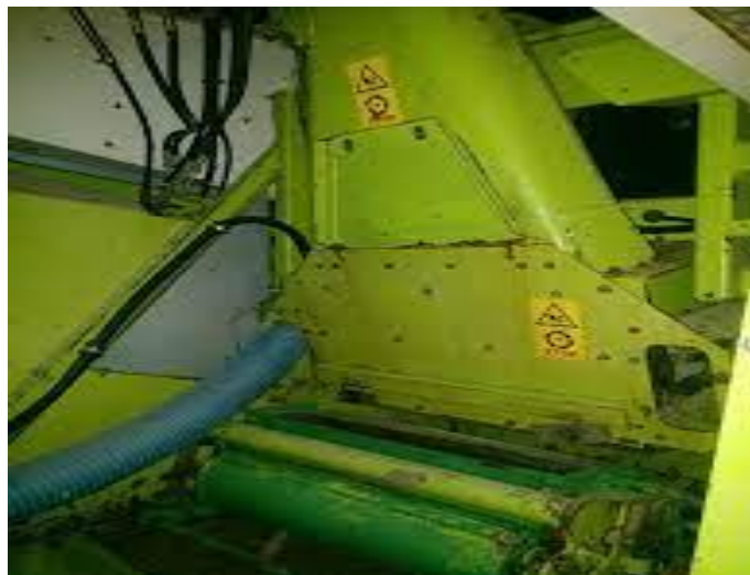
Slika 17. Mjenjačka kutija na grlu silokombajna i položaj ručke kojom se regulira dužina sjeckanja mase.
