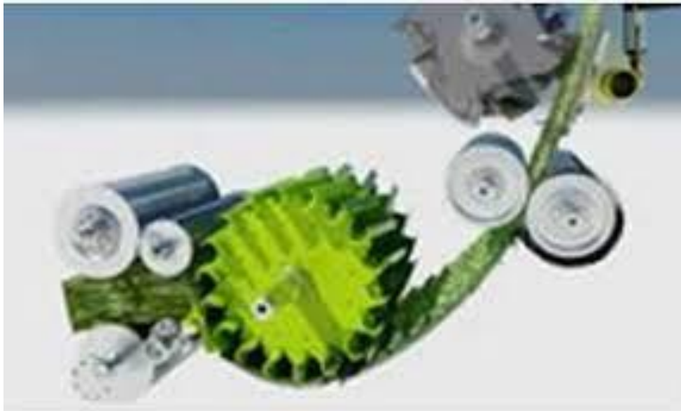
Slika 20. Prikaz rada ubrzivača materijala sa valjcima na grlu i bubanj sa noževima koji sjecka masu.
