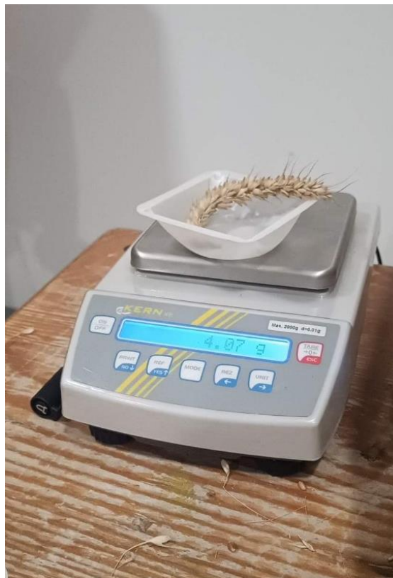
Slika 4. Mjerenje mase klasa
