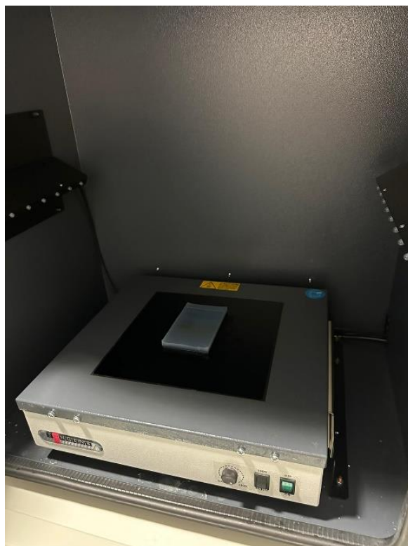
Slika 10. Priprema za snimanje gela pod UV svjetlom
