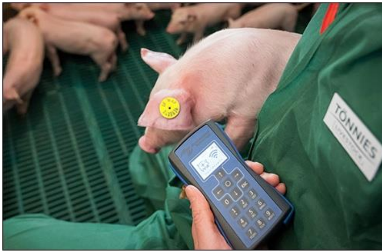
Slika 8. Primjena RFID u obliku ušne markice (Izvor: rainrfid.org)
