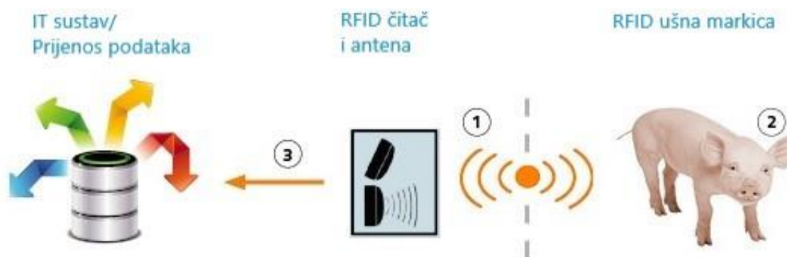
Slika 6. Princip rada RFID
