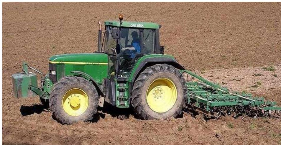
Slika 14. Sjetvospremač *Pecka* 4,20m
