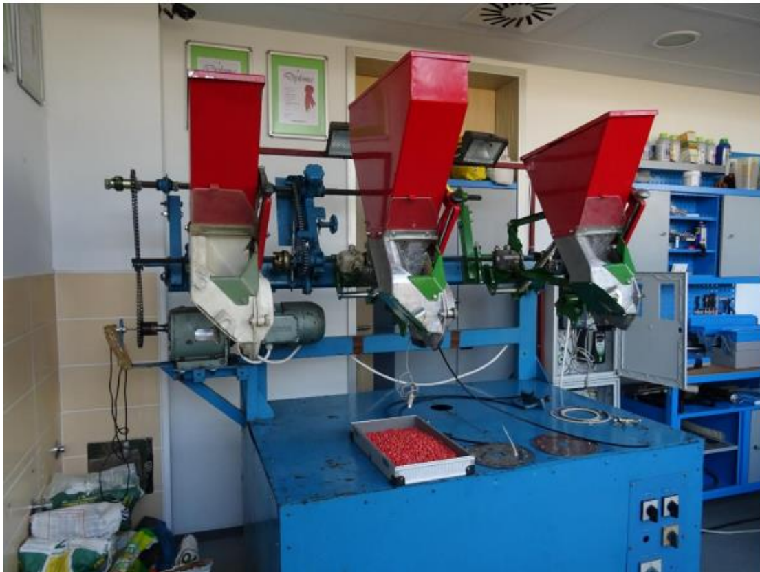
Slika 11. Ispitivanje pneumatske sijačice PSK
