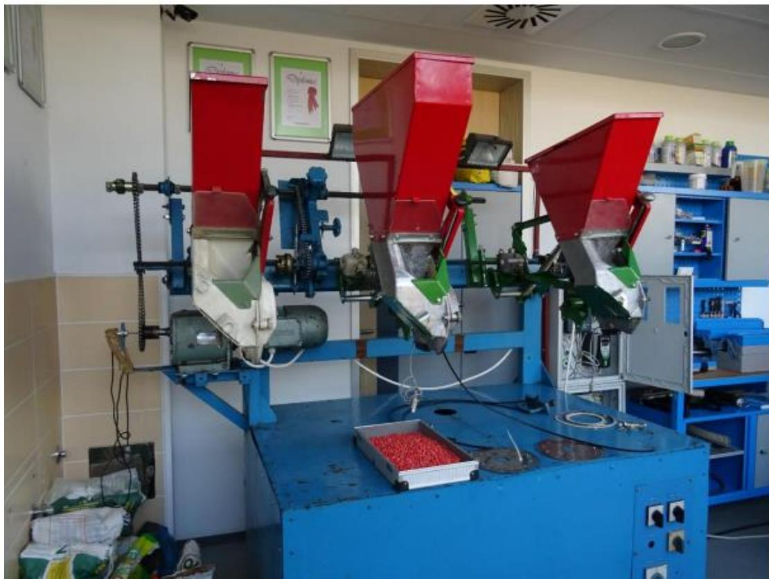
Slika 11. Ispitivanje pneumatske sijačice PSK
