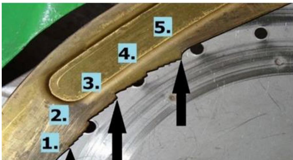
Slika 10. Skidač viška sjemena na PSK sijačici
