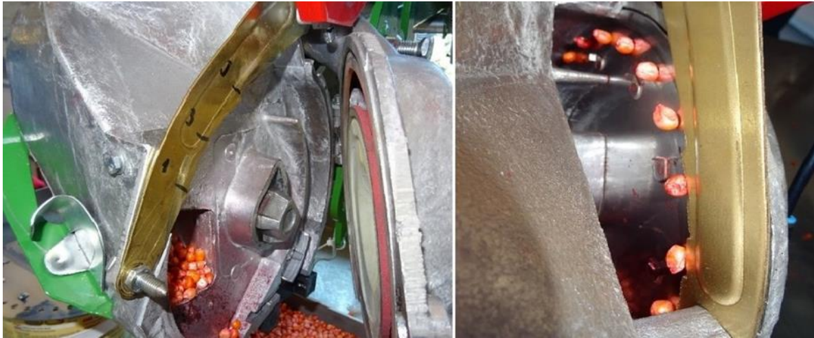
Slika 9. Komora za sjeme (lijevo) i skidač viška sjemena (desno) (Izvor: Banaj, 2020)
