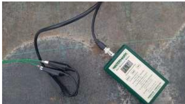
Slika 1. Watermark senzor (fotografija: Spišić, M., 2022.)
