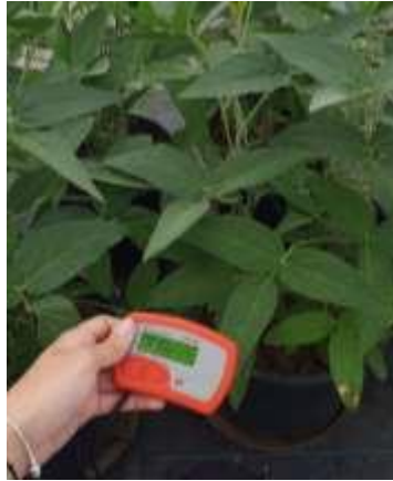
Slika 3. Mjerenje volumnog sadržaja vode u tlu (%vol.) (fotografija: Spišić, M., 2022.)
