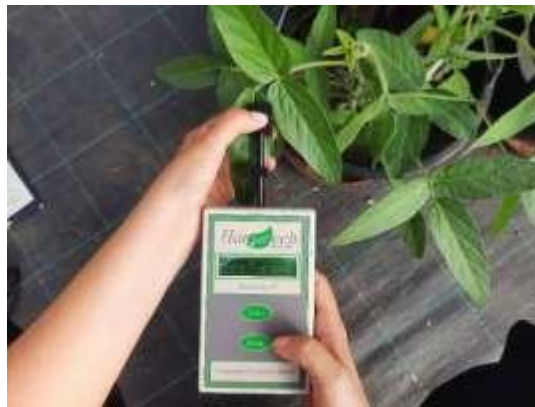
Slika 14. Senzor Chlorophyll content meter CL-01 (fotografija: Spišić, M., 2022.)
