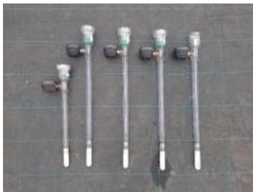
Slika 2. Tenziometar (fotografija: Spišić, M., 2022.)
