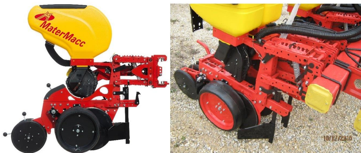
Slika 8. Sjetvena sekcija sijačice MaterMacc Twin Row-2
