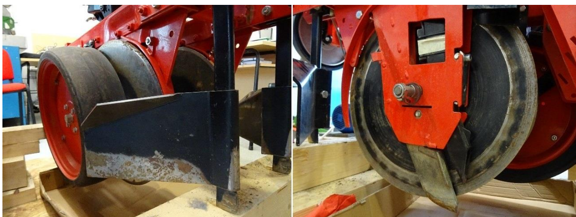
Slika 9. Uređaj za otklanjanje gruda tla u pravcu sjetve (lijevo)
