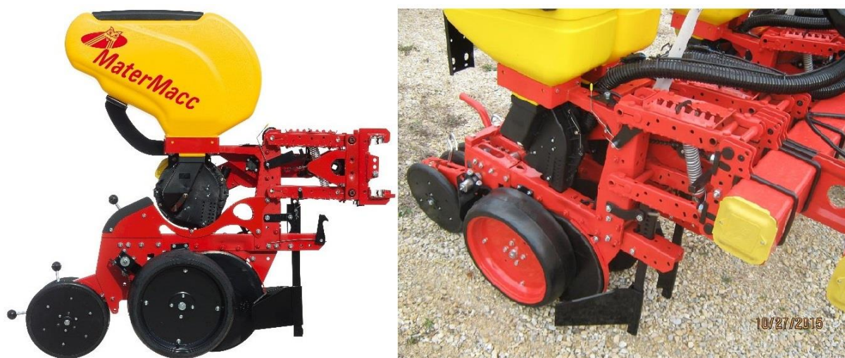
Slika 8. Sjetvena sekcija sijačice MaterMacc Twin Row-2
