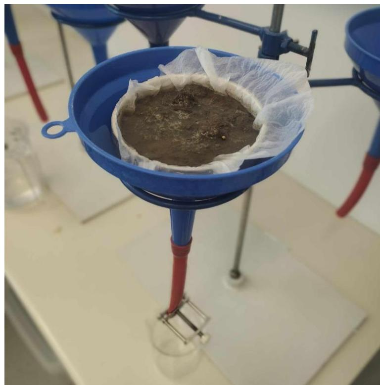
Slika 18. Baermanova metoda izdvajanja nematoda iz tla pomoću lijevaka
