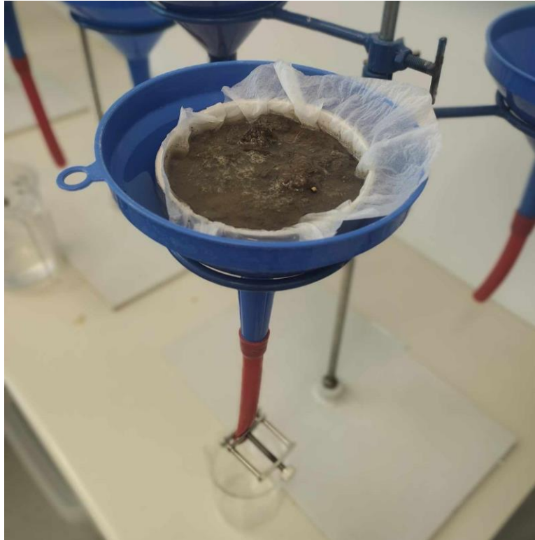
Slika 18. Baermanova metoda izdvajanja nematoda iz tla pomoću lijevaka Izvor: Autorica, Gloria Ninković
