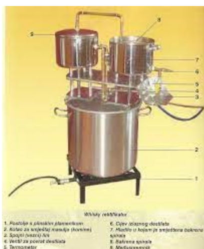
Slika 7. Whisky rektifikator (izvor: https://issuu.com/zokspile/docs/rakija/31 )
