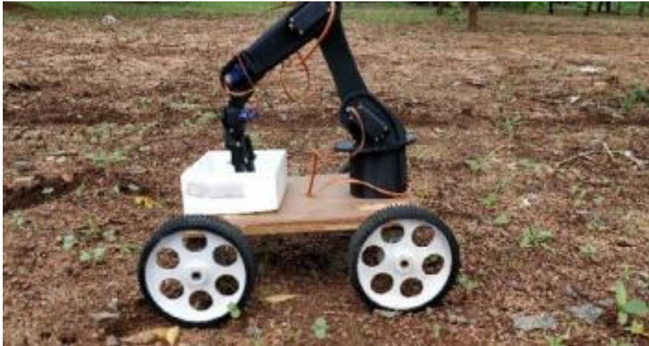
Slika 4. Testiranje robota na polju (uzimanje sjemena)
