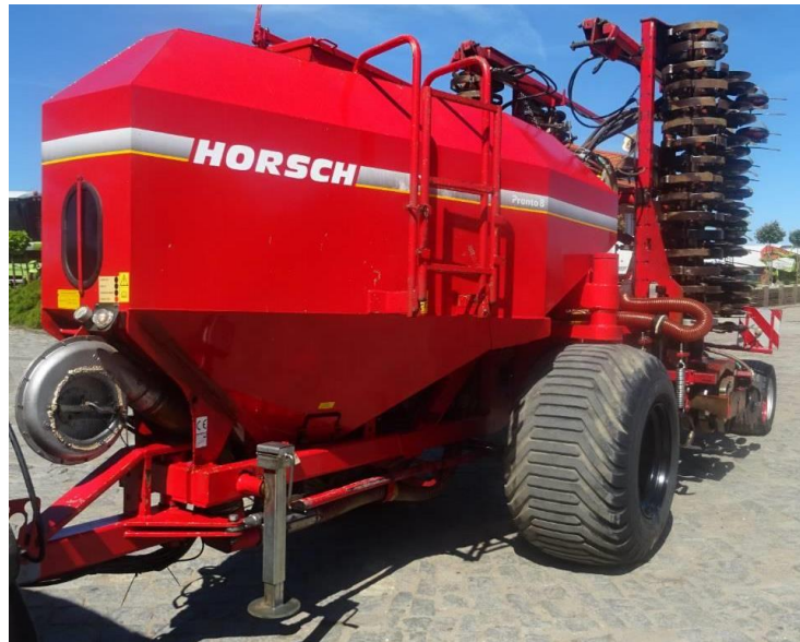
Slika 22. Sijačica Horsch Pronto 8 DC ; spremnik s poklopcem
