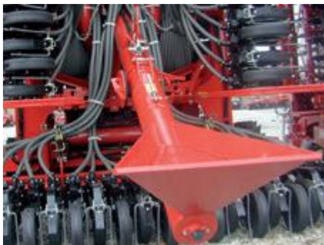
Slika 28. Pužnica za punjenje spremnika
