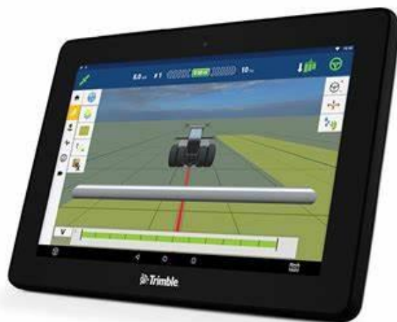
Slika 11. Sustav za asistenciju prilikom upravljanja proizvođača Trimble
