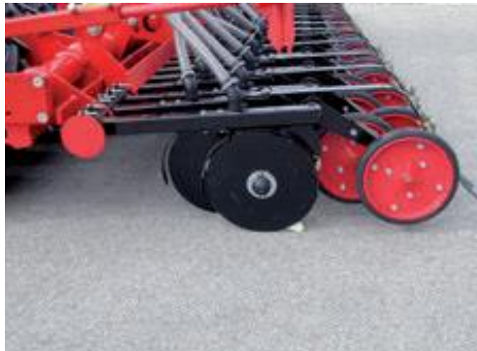
Slika 26. Sklop raonika za sisanje
