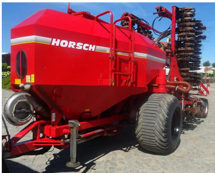
Slika 22. Sijačica Horsch Pronto 8 DC ; spremnik s poklopcem
