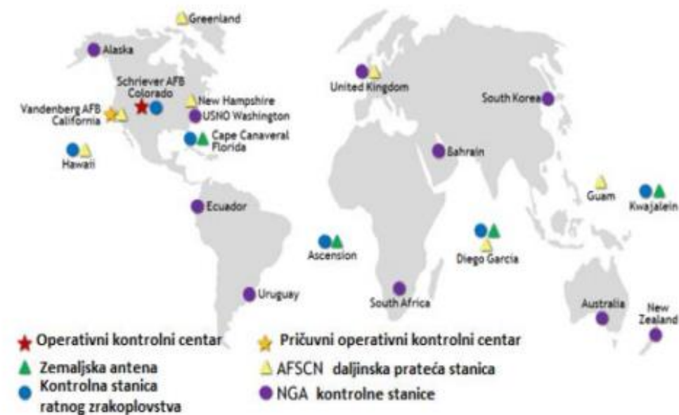
Slika 5. Kontrolni segmenti GPS sustava raspoređeni na Zemlji
