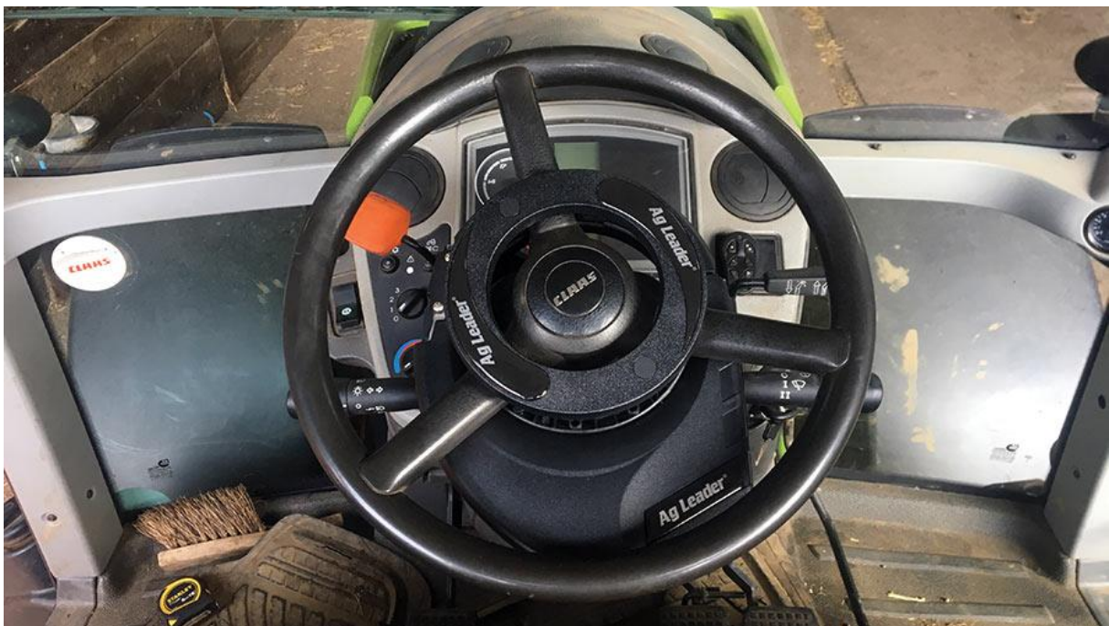
Slika 12. Sustav za automatsko vođenje proizvođača Ag Leader Ontrac 3
