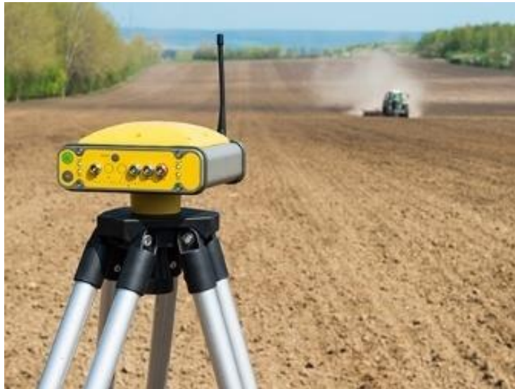
Slika 13. Bazna stanica za RTK metodu
