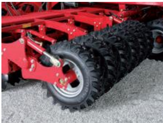
Slika 25. Packer valjak s pneumaticima
