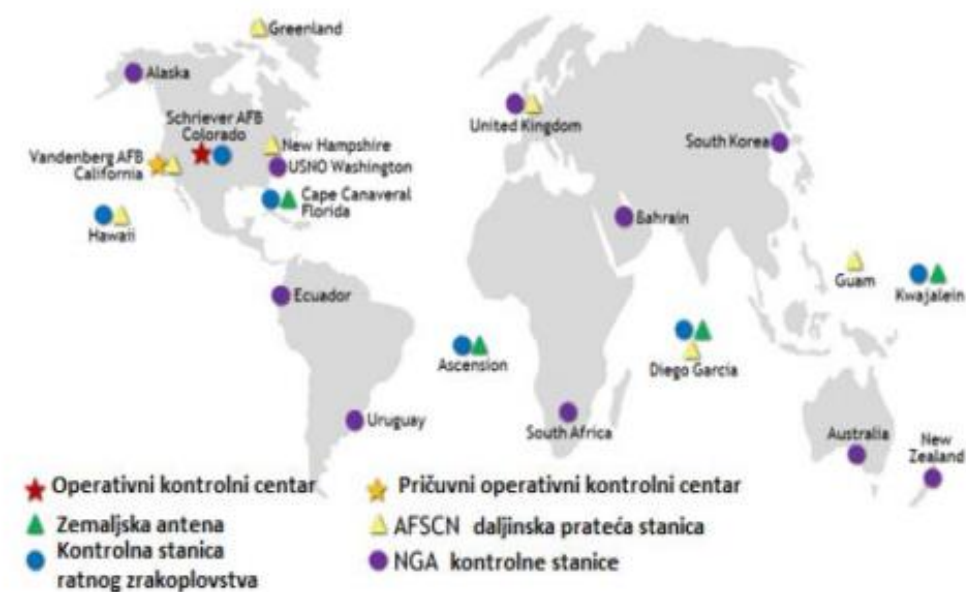
Slika 5. Kontrolni segmenti GPS sustava raspoređeni na Zemlji
