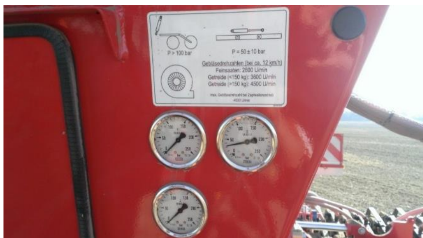
Slika 21. Instrumenti za očitavanje veličina rada ventilator
