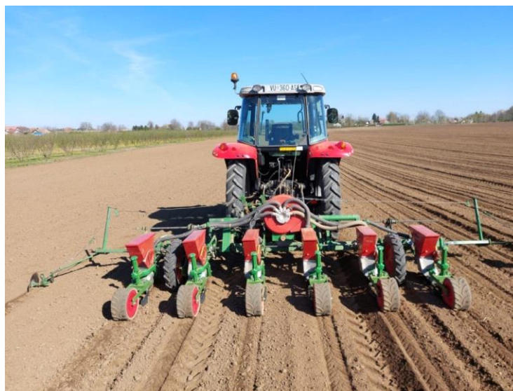
Slika 7. Sijačica OLT PSK (Sekulić, 2023.)
