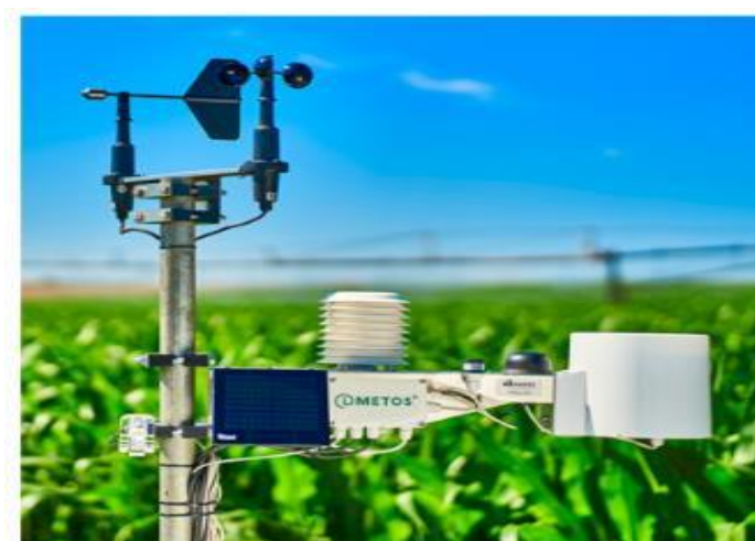
Slika 3. iMetos aparat za prognozu.
