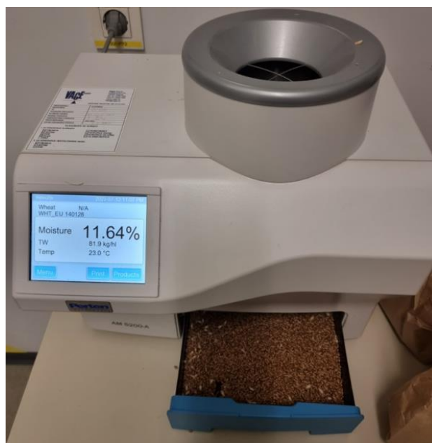
Slika 9. Uređaj za određivanje hektolitarske mase (izvor: Iljkić, D.)
