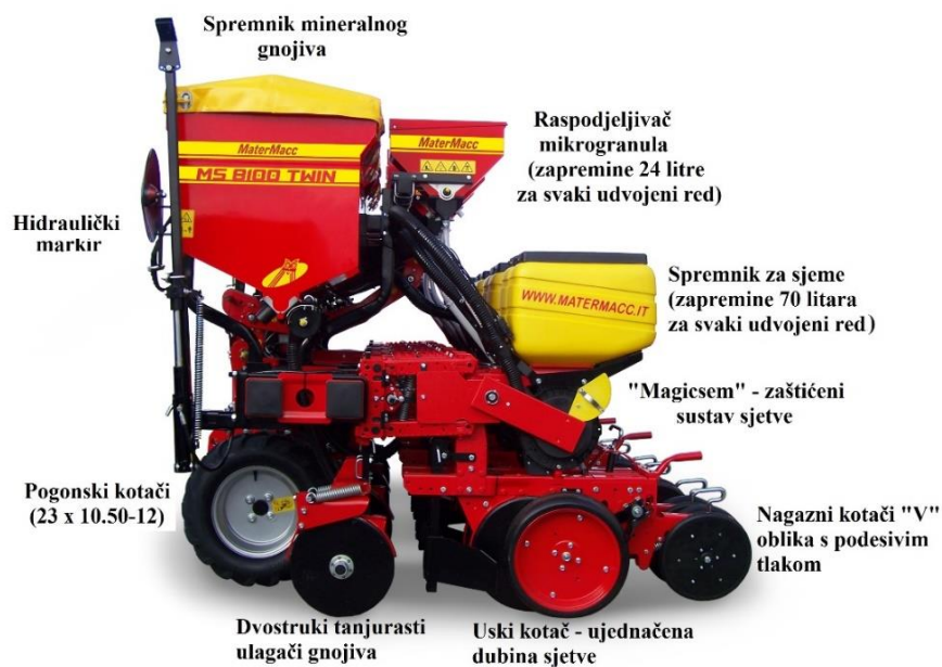
Slika 6. Glavni sustavi sijačice MaterMacc Twin row – 2
