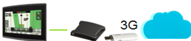
C-Box Wi-Fi + 3G USB uređaj (uvjet je 3G pokrivenost)
