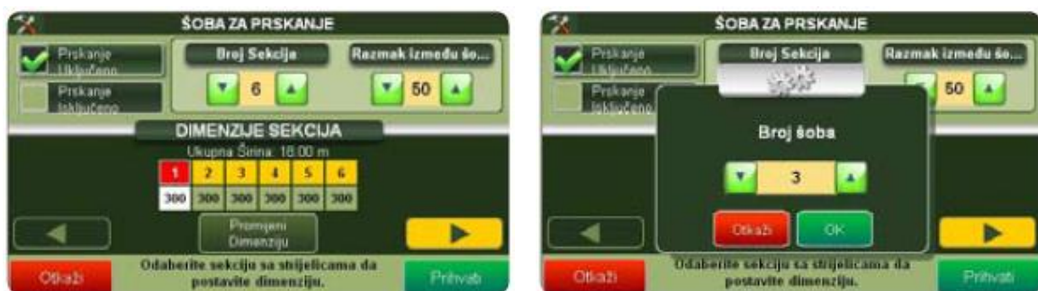
Slika 9. Namještanje mlaznica za prskanje (G6 Farmnavigator priručnik za korisnike)
