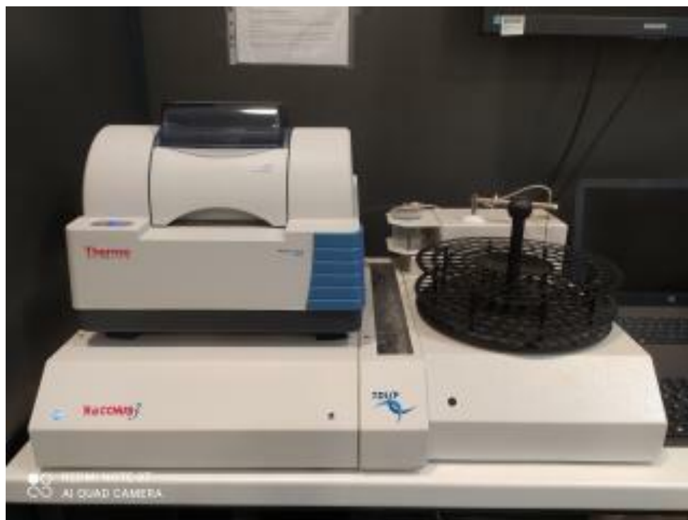
Slika 5. Uređaj Bacchus za fizikalno-kemijsku analizu vina
