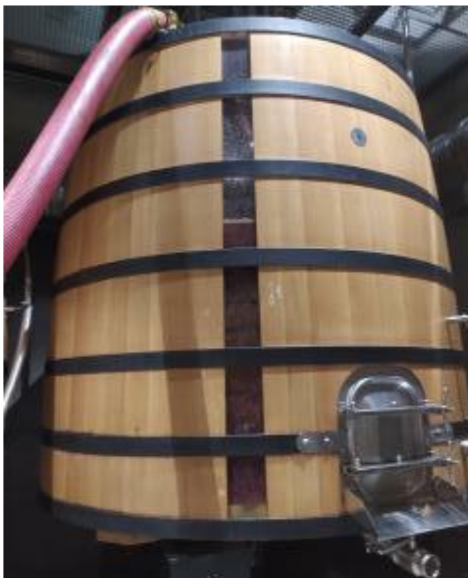
Slika 1. Punjenje masulja u vinifikator na maceraciju
