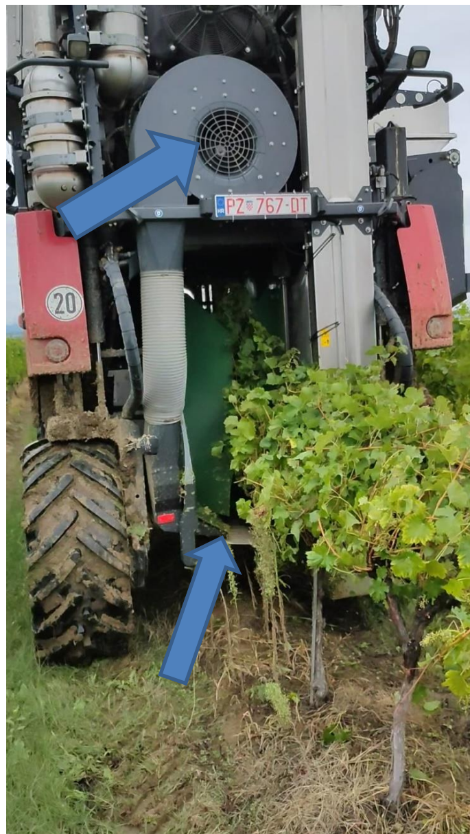
Slika 23. Ventilator za lišće
