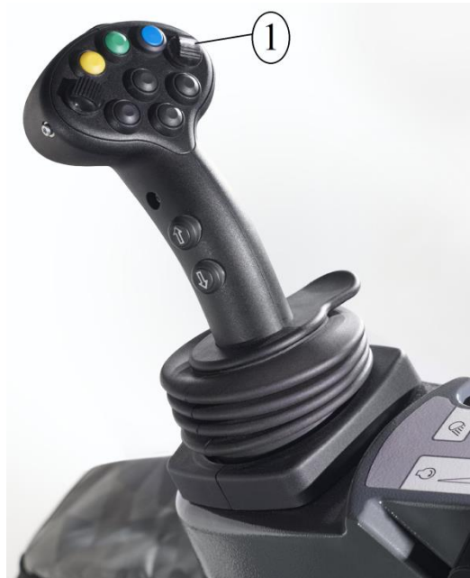
Slika 38. Tipka (1) otvaranje spremnika
