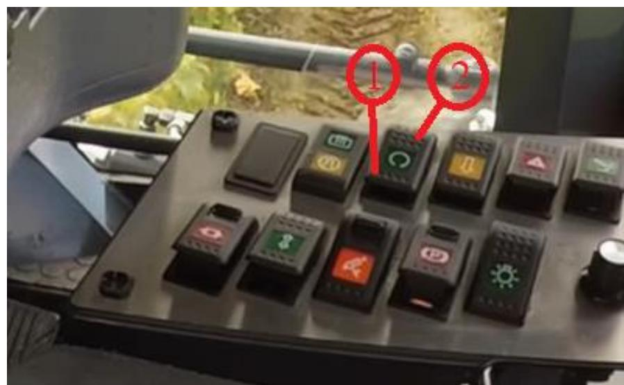
Pužni transporter pokreće se prekidačem iz kabine kombajna. Pritiskom prekidača (1) pužni transporter kreće se prema stražnjem dijelu kombajna, dok pritiskom prekidača (2) pužni transporter kreće se prema prednjem dijelu kombajna.
