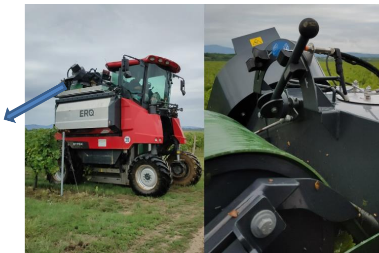
Slika 26. Rad gornjeg usisnog ventilatora
