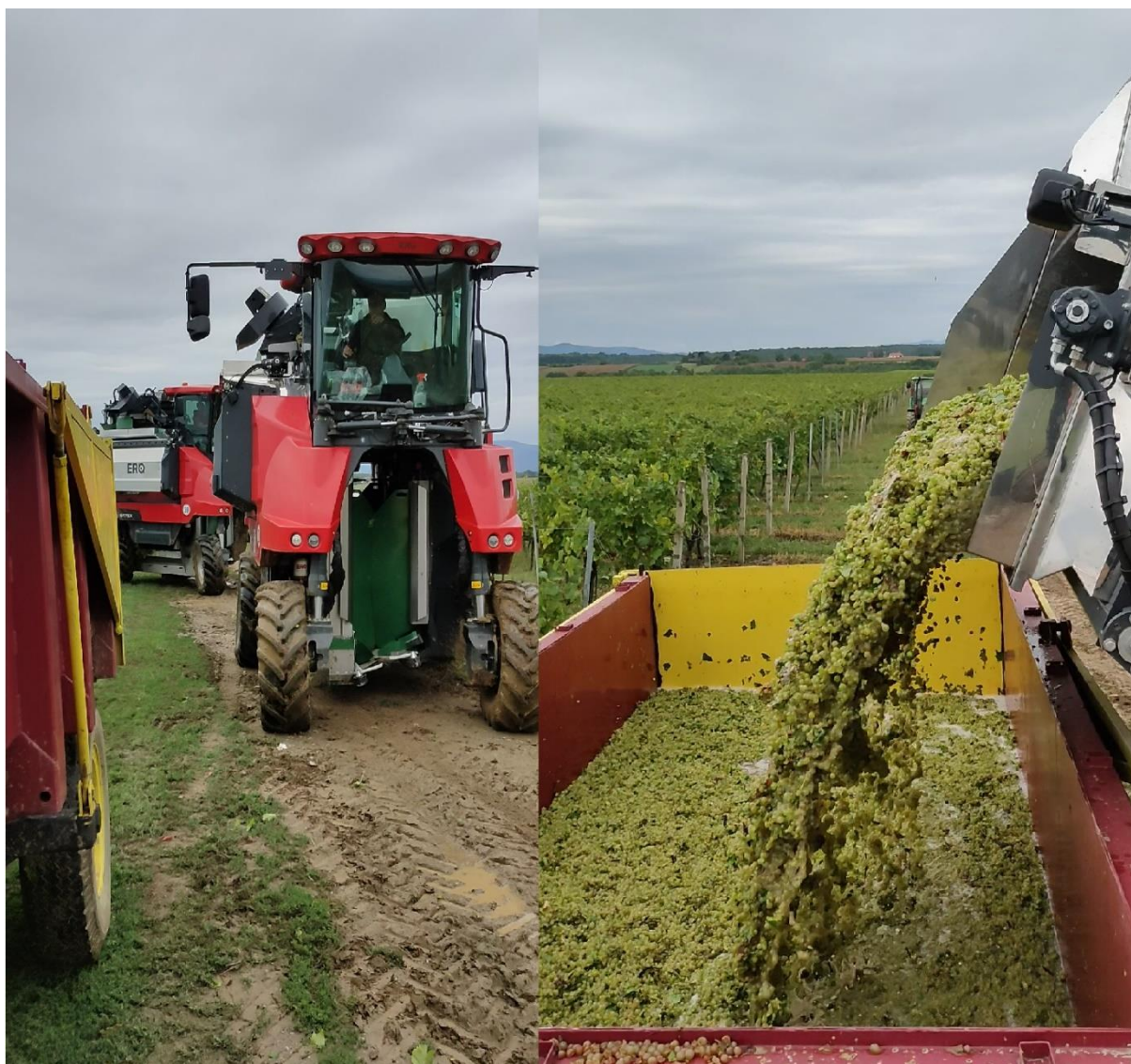
Slika 36. Bočno pražnjenje spremnika
