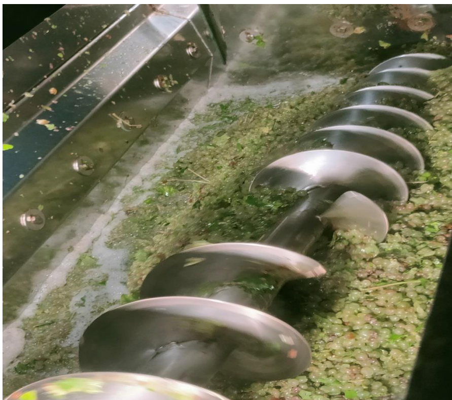
Slika 35. Pužni transporter u spremniku
