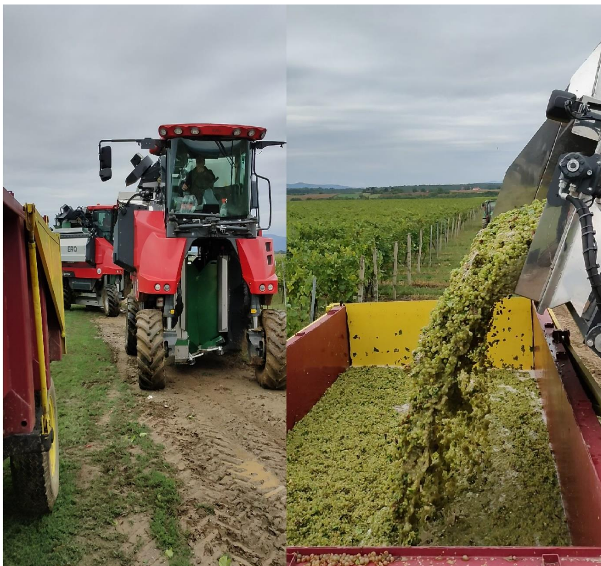
Slika 36. Bočno pražnjenje spremnika
