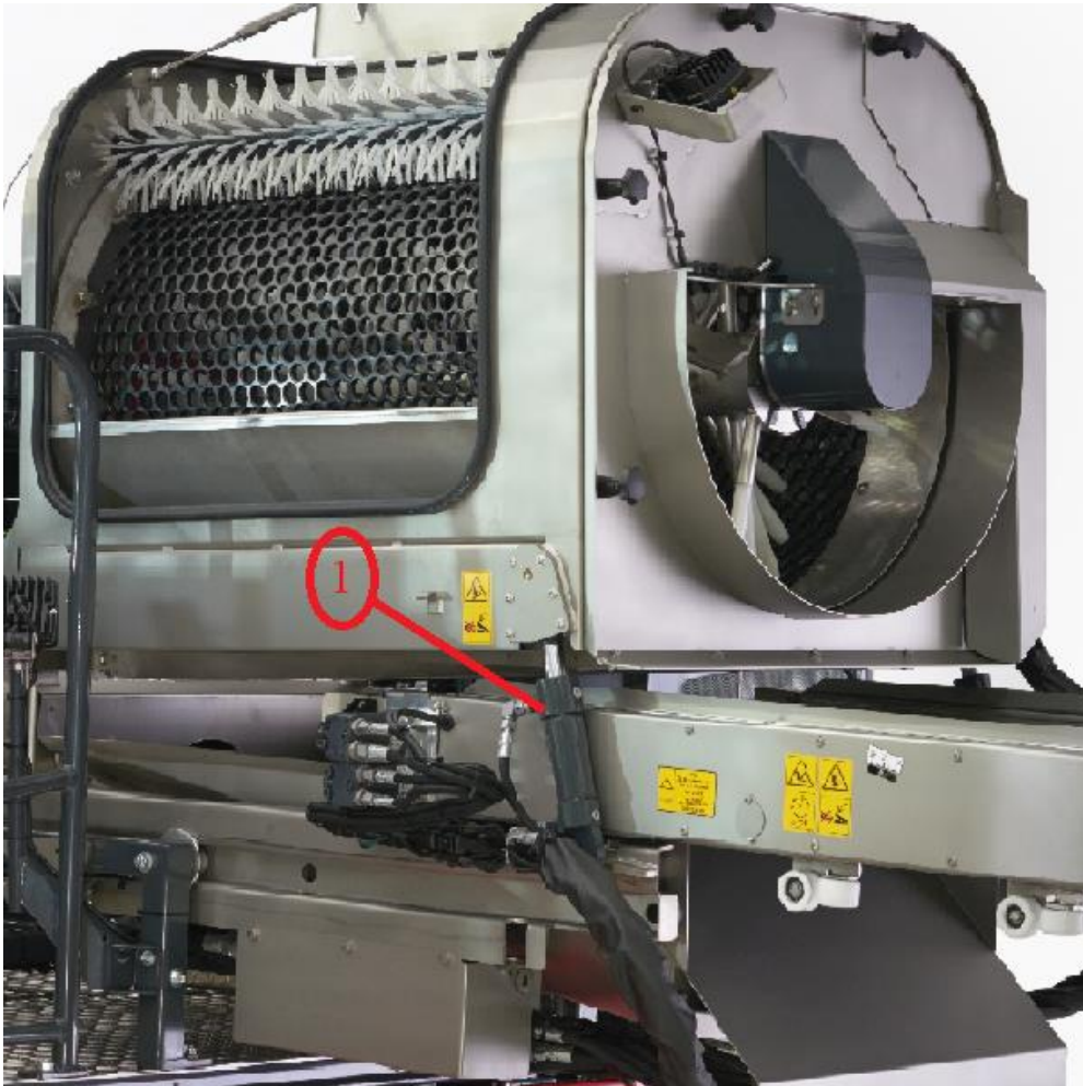
Slika 30. Cilindri (1) koji održavaju nagib ruljače
