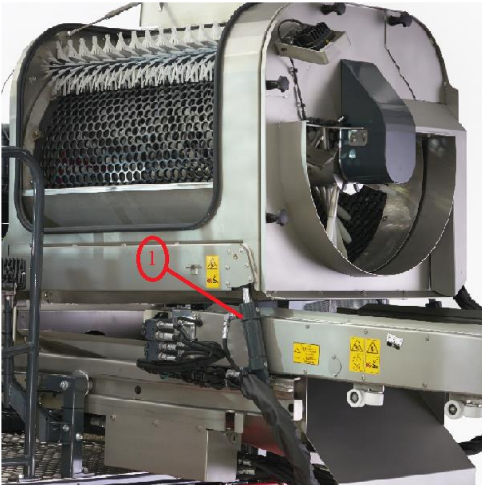
Slika 30. Cilindri (1) koji održavaju nagib ruljače
