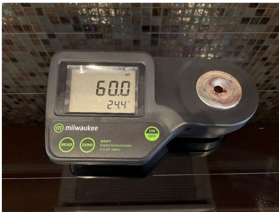
Slika 2. Mjerenje količine šećera refraktometrom (vlastiti izvor)
