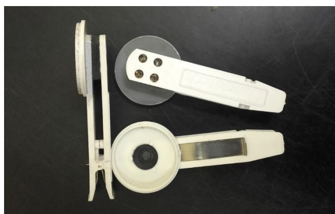
Slika 3. Standardne štipaljke koje se koriste u postupku mjerenja fluorescencije (foto: Vlatko Galić).
