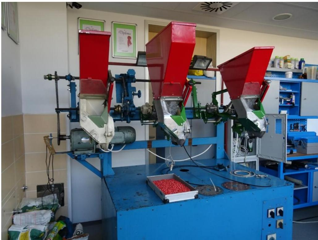
Slika 9. Ispitni stol za pneumatske sijačice
