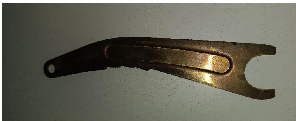
Slika 8. Skidač viška sjemena
