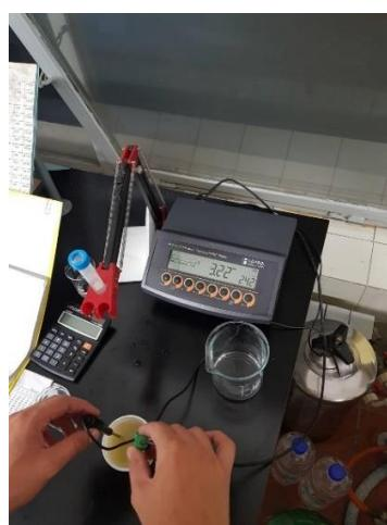
Slika 9. Postupak određivanja pH-vrijednosti
