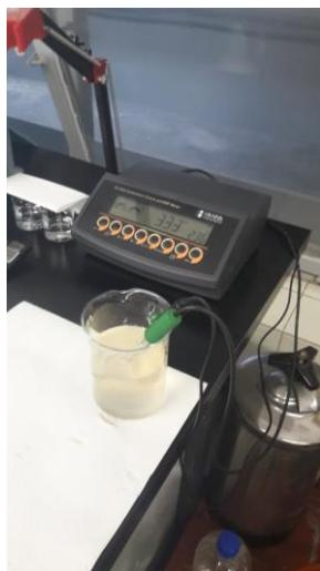
Slika 8. pH-metar i određivanje pH-vrijednosti
