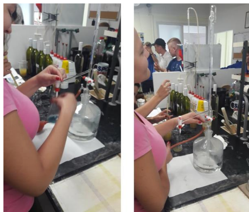
Slika 6. Uređaj za titriranje i postupak titracije Izvor: Autor
