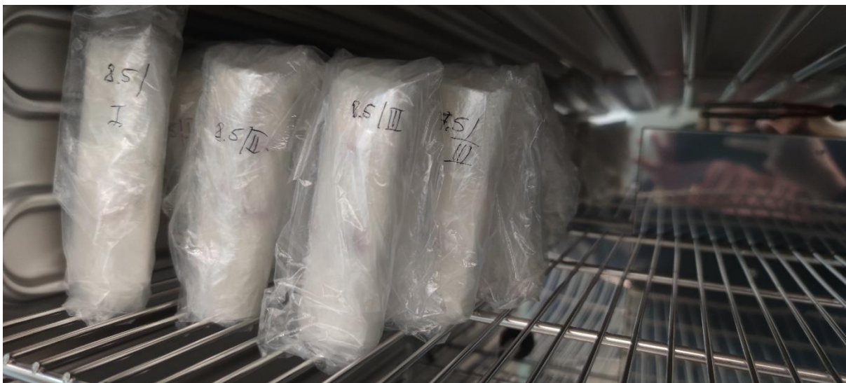
Slika 6. Zamotan filter papir u PVC vrećici s odgovarajućom oznakom u klima komori (Izvor: Ervačić, L.)
