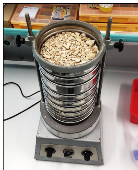
Slika 6. Uređaj za suho prosijavanje skeleta
