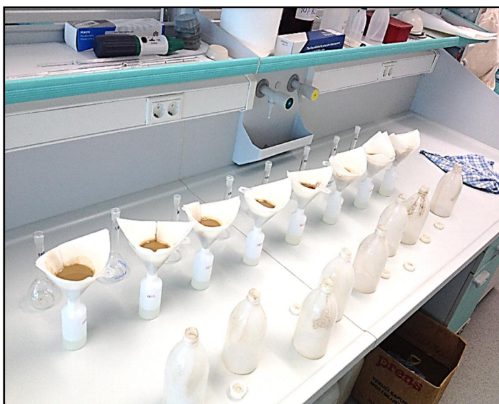
Slika 11. Filtriranje uzoraka (AL-metoda)
