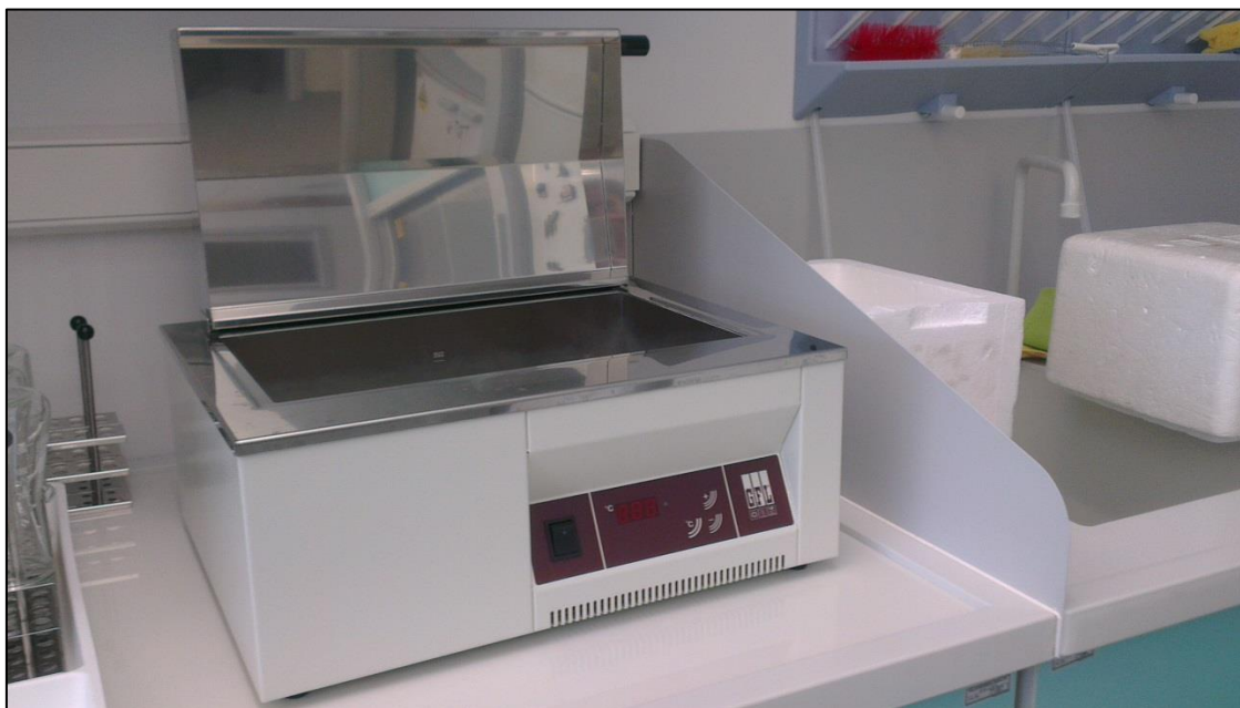
Slika 2. Vodena kupelj za inkubaciju tubica (foto original; S. Guberac)
